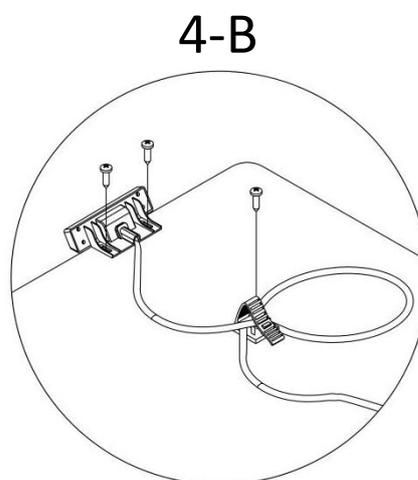
Branchez tous les connecteurs d'alimentation électrique, puis serrez les vis du cadre. (Vis : 3 pièces ST4x16, 3 pièces de porte-câble)
